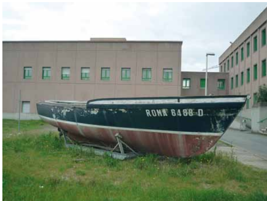
Fig. 4 - La motobarca di ferroemento "La Giuseppa" nel Dipartimento di Ingegneria Civile dell'Università di Roma Tor Vergata prima dell'inizio del restauro (foto autori)
