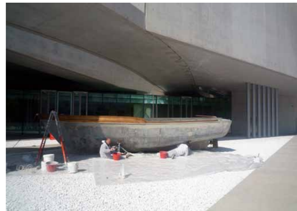
14 Détail de la coque en ferrociment du bateau à moteur « La Giuseppa », 1972.
